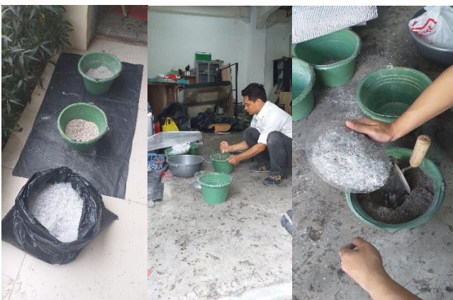
Gambar 6. Proses Pembuatan Batako dengan Campuran Cacahan Plastik yang Dilakukan di Bengkel Kerja Fakultas Teknik UPN "Veteran" Jakarta.
