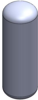
Gambar 10. Pemodelan Geometri Bejana Tekan
