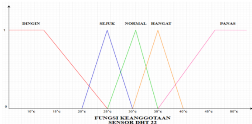
Gambar 5. Fungsi Keanggotaan Sensor DHT 22 - 2
