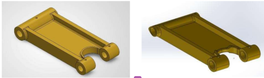
Gambar 4.13. Perbandingan Geometri (a) Desain Awal dan (b) Desain Optimasi
