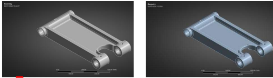
Gambar 4. 11. Hasil Desain dengan Pertimbangan Manufaktur, (a) Material AISI 4140 (b) Material AISI 4340
