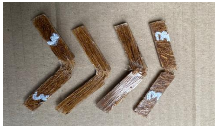
Gambar 7. Hasil Spesimen Setelah Di Uji Impak
