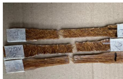
Gambar 5. Hasil Spesimen Setelah Di Uji Tarik
