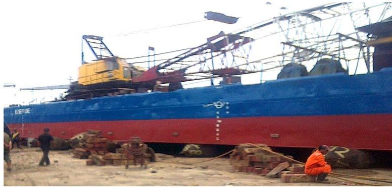
**Gambar 6 Tongkang Neptune dengan Dok Sistem Airbags**
