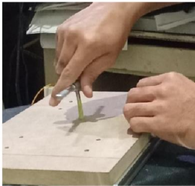
Gambar 4.6 Pembuatan Ulir Dudukan Meja Vakum
