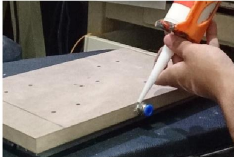
Gambar 4.5 Pengaplikasian Sealant Pada Nepel
