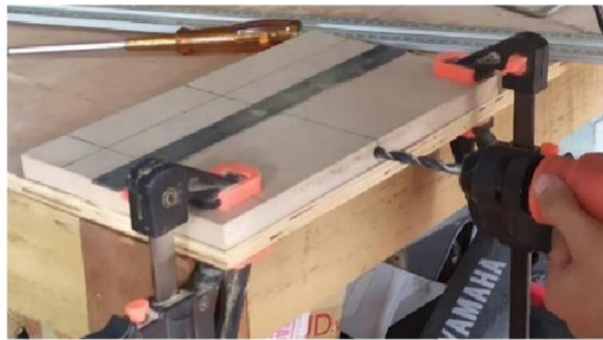
Gambar 4.3 Pengeboran Lubang Inlet
