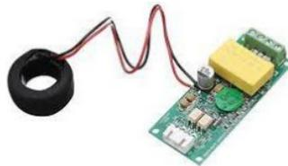
Gambar 2.7 Modul Sensor PZEM-004T
