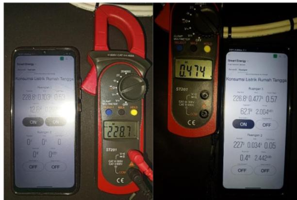
Gambar 4.10 Pengujian Akurasi Sensor
