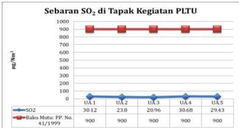
**Gambar 43.** Konsentrasi Sebaran Sulfur Dioksida (SO<sub>2</sub>) di Udara Ambient Tapak Kegiatan PLTU
