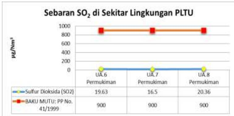
**Gambar 44.** Konsentrasi Sebaran Sulfur Dioksida (SO<sub>2</sub>) di Permukiman Penduduk Sekitar Tapak Kegiatan PLTU
