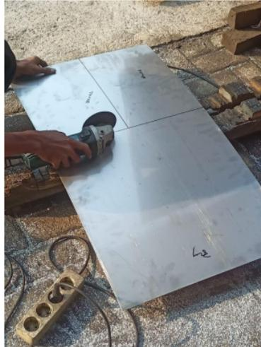
Gambar 4. 5 proses pemotongan menggunakan gerinda tangan
