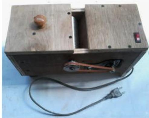
Gambar 2. 2 mesin parut kelapa
