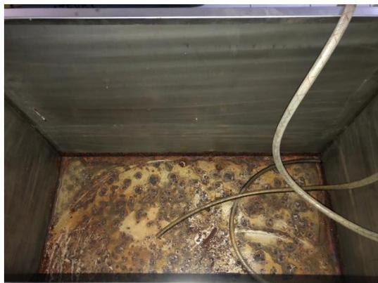
**Gambar 1. 1** Korosi Pada Mesin Distilasi
