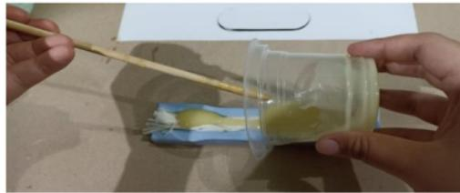
Gambar 4. 8 Proses pencetakan Hand lay up
