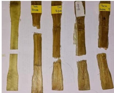
3 Gambar 4. 14 Spesimen Setelah Uji Tarik Serat Pendek
