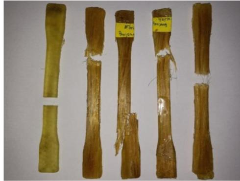
Gambar 4. 13 Spesimen Setelah Uji Tarik Serat Panjang
