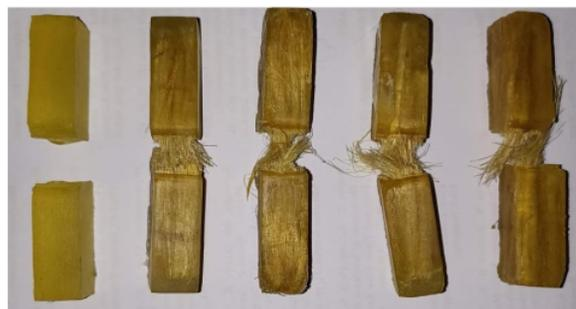
Gambar 4. 19 Spesimen Setelah Uji Impak Serat Panjang
