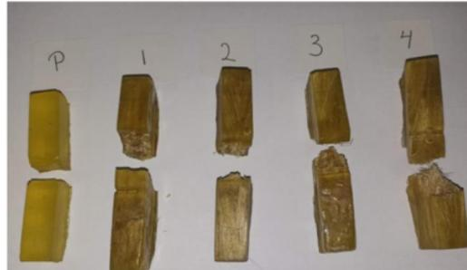
Gambar 4. 20 Spesimen Setelah Uji Impak Serat Pendek
