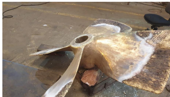
Gambar 8. Hasil Pengelasan Pada Daun Baling- Baling
