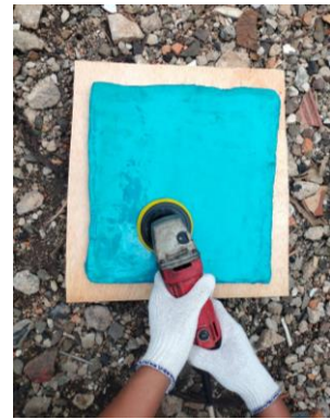
Gambar 7. Menghaluskan Permukaan Lapisan Fiberglass
