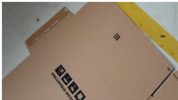
**Gambar 1. 4** Defect Joint Glue Tidak Menempel Pada Mesin Finishing Glue
