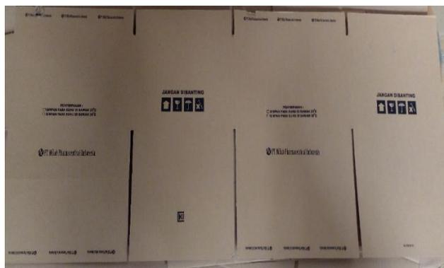
**Gambar 1. 3** Defect Panjang Potongan Berbeda Pada Mesin Slotter
