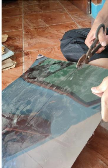
Gambar 4. 9. Proses Pemotongan Plat Stainless dengan Gunting Plat
