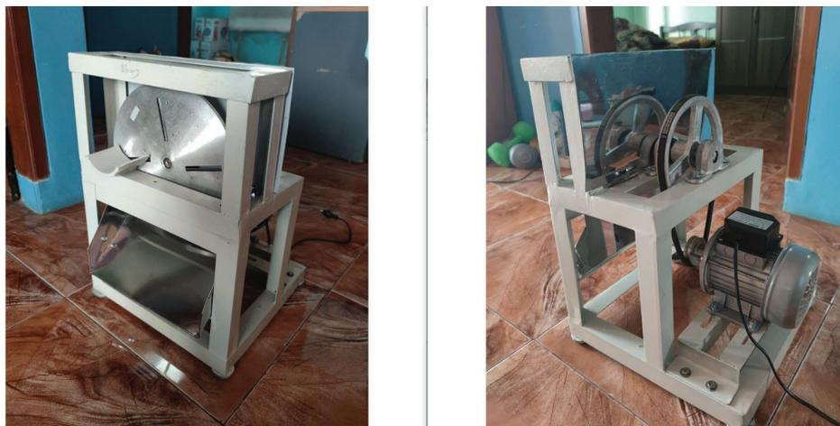
Gambar 4. 15. *Prototype* Mesin Pengiris Pisang
