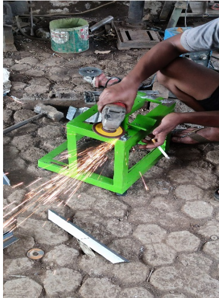
Gambar 4.17 Proses Gerinda Permukaan
