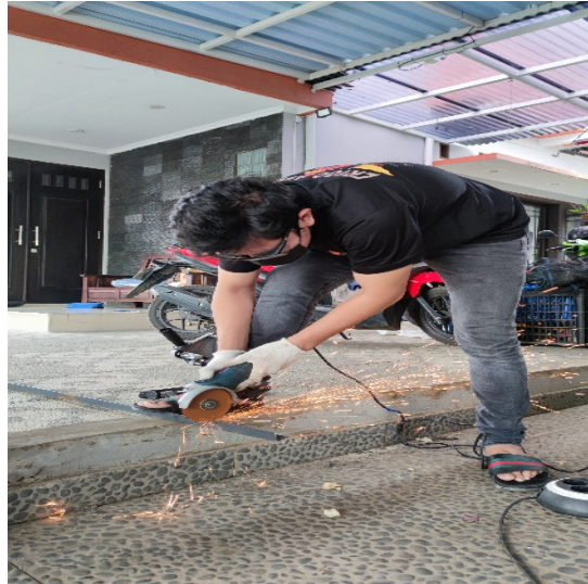
Gambar 4.14 Pemotongan Dengan Gerinda
