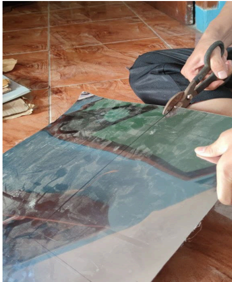
Gambar 4.15 Proses Pemotongan Dengan Gunting Plat
